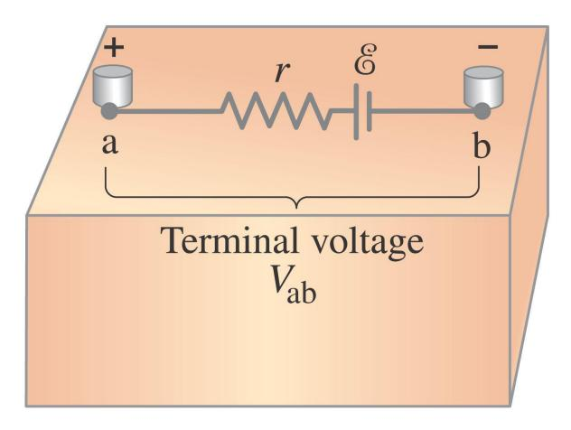
Μια 65.0-Ω αντίσταση συνδέεται με μπαταρία 12.0 V που έχει εσωτερική αντίσταση 0.5 Ω. Βρείτε (a) το ρεύμα του κυκλώματος (b) την τάση εξόδου της μπαταρίας  $V_{\rm ab}$ , και (c) την ισχύ που καταναλώνεται στις αντιστάσεις R και r.
