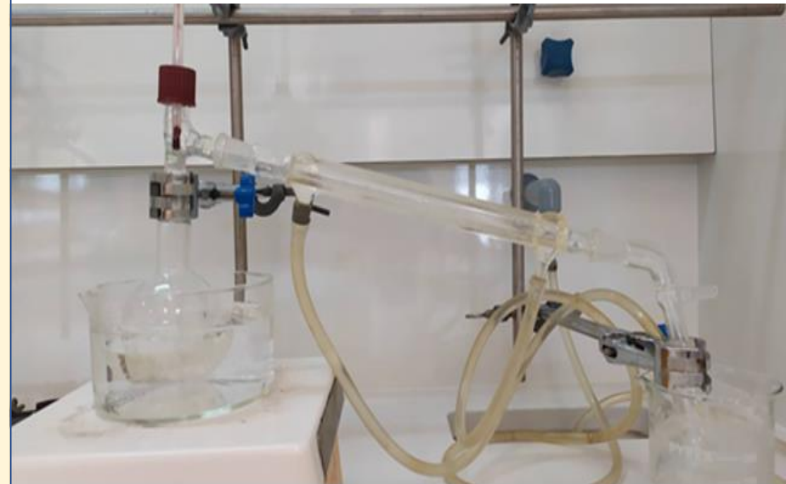
Εικόνα: Απλή απόσταξη διαλύτη 1-προπανόλη
