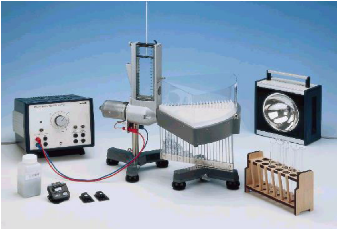
Σχήμα A5.3.1: Πειραματική συσκευή, για τη μέτρηση της κατανομής ταχυτήτων ενός μοντέλου αερίου.
