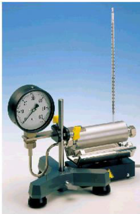
Σχήμα A1.3.1.1: Πειραματική συσκευή για τη μέτρηση της τάσης ατμών συναρτήσει της θερμοκρασίας.
