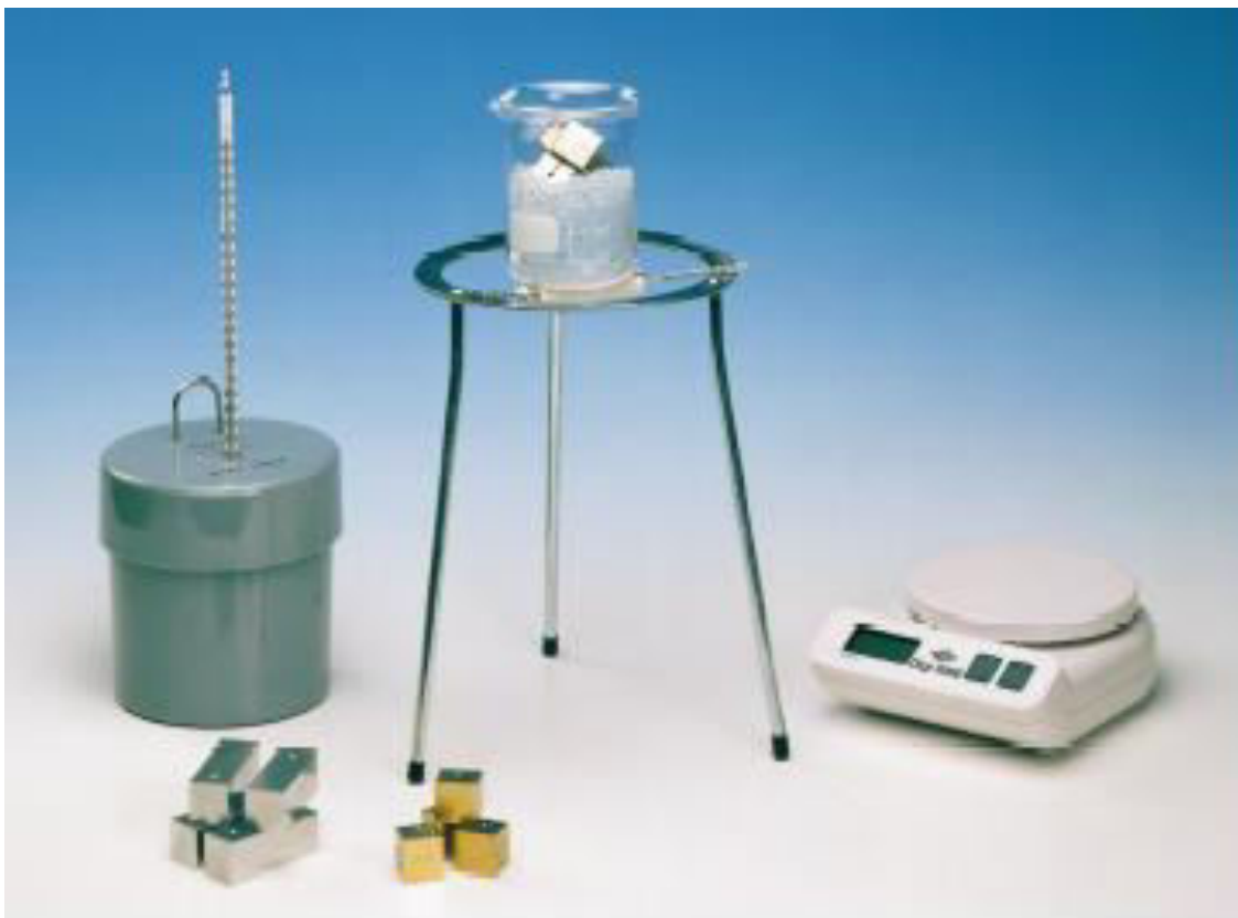
Σχήμα B8.3.1 Πειραματική διάταξη για τον προσδιορισμό της θερμοχωρητικότητας των μετάλλων.
