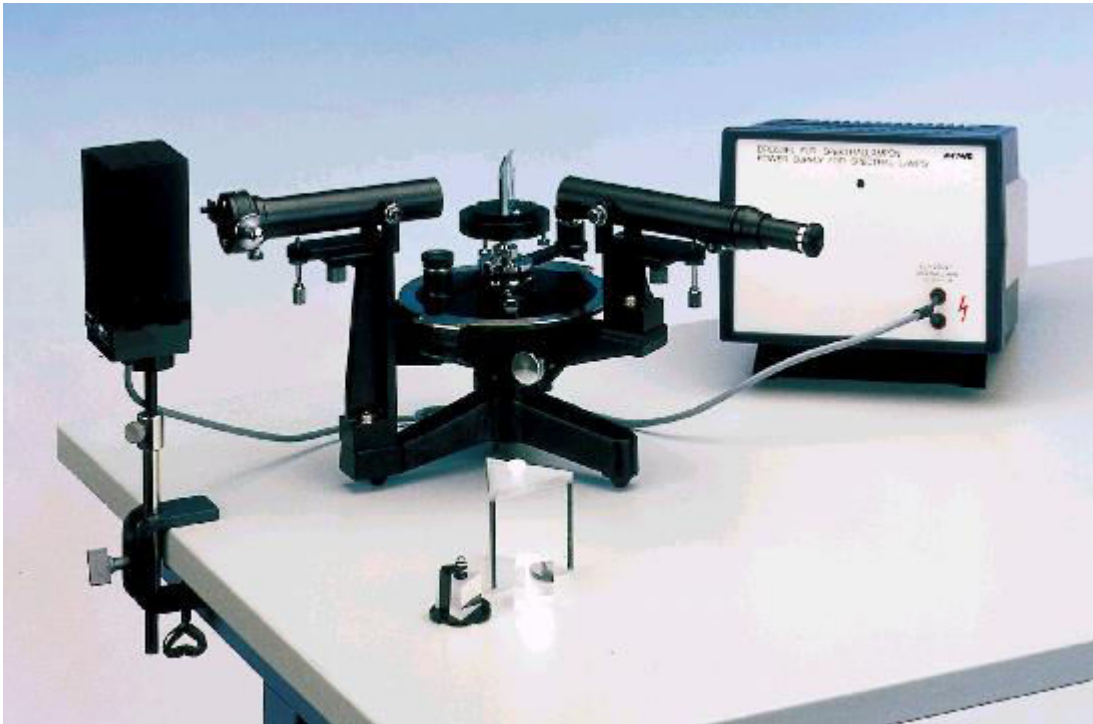
Σχήμα Α7.3.1: Πειραματική συσκευή για το προσδιορισμό του δείκτη διάθλασης διάφορων υλικών.
