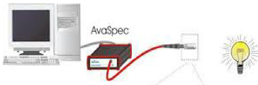
Σχ. 2 Σχηματικό διάγραμμα πειραματικής διάταξης καταγραφής φάσματος εκπομπής από λυχνία με φασματόμετρο οπτικών ινών
