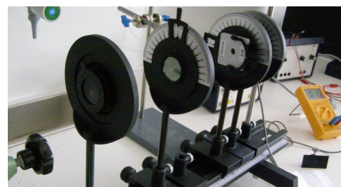
Σχ.3 Τμήμα της πειραματικής διάταξης. Διακρίνονται η ίριδα, ο πρώτος πολωτής, το πλακίδιο καθυστέρησης, και ο δεύτερος πολωτής σε κατάλληλα στηρίγματα ευθυγραμμισμένα σε οπτικό φορέα καθώς και το πολύμετρο.
