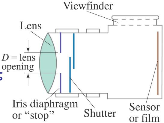
Η ψηφιακές μηχανές χρησιμοποιούν αισθητήρες CCD (charge coupled devises) αντί για φιλμ.
