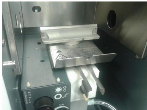
2. Η σχισμή του καυστήρα πρέπει να είναι παράλληλη με τη διαδρομή του φωτός. Ελέγχεται τοποθετώντας τη κάρτα ελέγχου στα άκρα της σχισμής του καυστήρα και τροποποιείται από τα κουμπιά A και B που ρυθμίζουν το ύψος και την οριζόντια θέση του καυστήρα αντίστοιχα.
