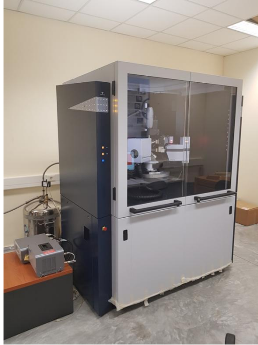
Εικόνα 11: Περιθλασίμετρο ακτίνων-Χ για μονοκρυστάλλους. Bruker D8 Venture dual source (Ιμ3).
