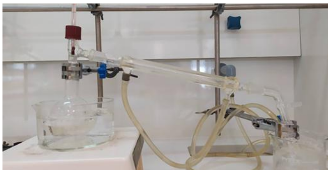
Εικόνα 8: Απλή απόσταξη διαλύτη 1-προπανόλη
