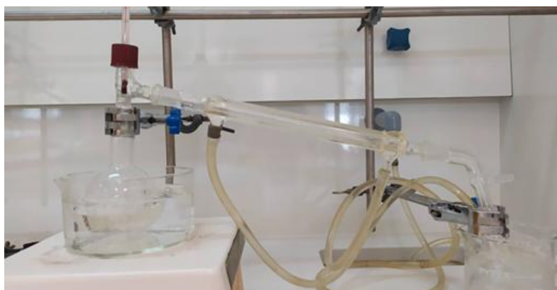
Εικόνα: Απλή απόσταξη διαλύτη 1-προπανόλη
